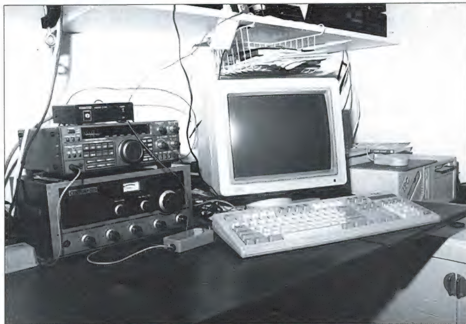
De PC via SCANNER aangesloten op een R-5000. Boven op de ontvanger staat het RS-232 kastje dat bij de R-5000 hoort. Links naast het toetsenbord is de audio-interface behorende bij het programma SCANNER te zien.
